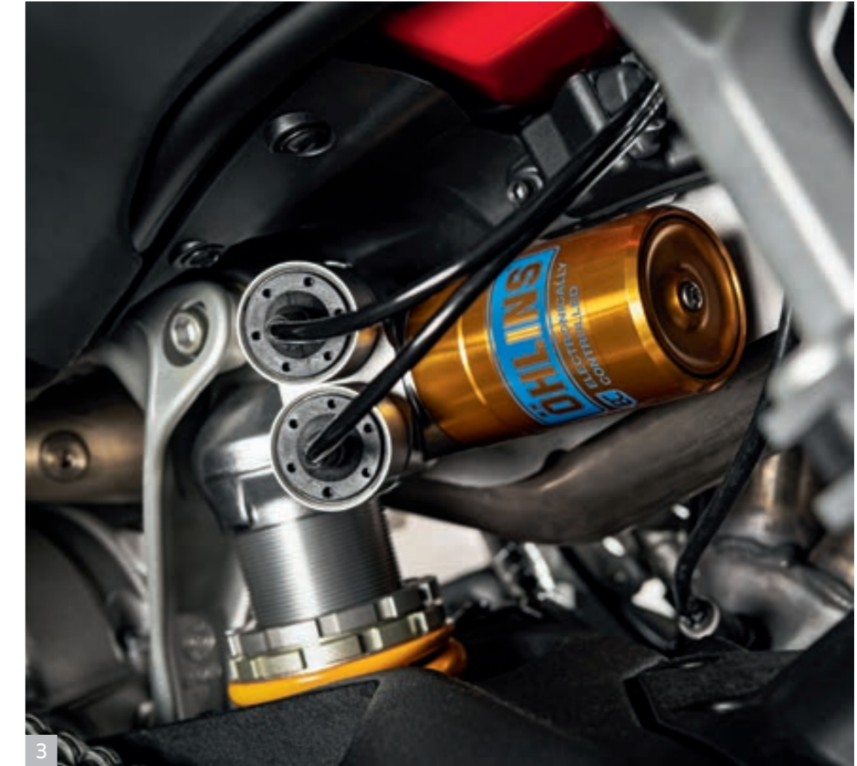
3 Öhlins Smart EC TTX36 damper
