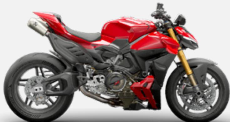
Con questa configurazione, destinata all'uso esclusivo in circuito, il nuovo Streetfighter V4 è pronto per sfidare il cronometro: lo scarico completo Akrapovič innalza la potenza e abbassa il peso, La frizione a secco svolge una più efficace funzione anti-saltellamento e i freni anteriori sono ancora più efficienti, mentre il nuovo sistema DDL di acquisizione dati consente di analizzare le prestazioni al termine di ogni sessione.
